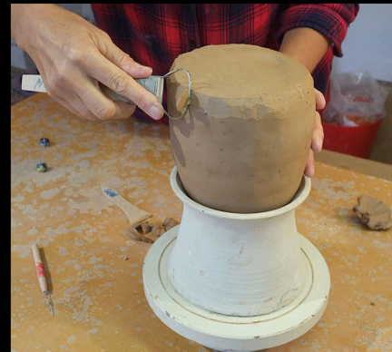
25. Retourner la pièce sur un support. Avec un outil tranchant appelé mirette, retirer l'excédent de terre et ensuite, lisser avec les doigts.
