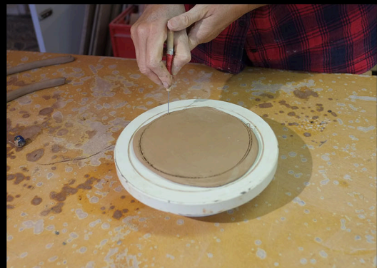
2. Avec une aiguille, déterminer la base de la théière
