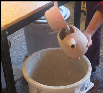
38. Après avoir cuit la théière une première fois à 950°, émailler la théière à l'intérieur comme à l'extérieur.
