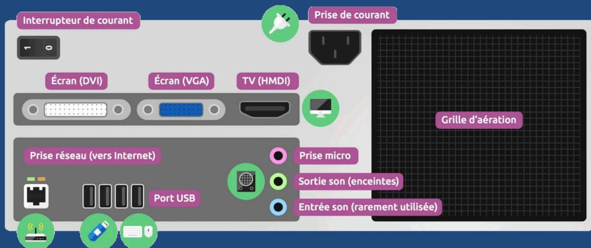
Sur les anciens modèles, on pourra encore trouver d'autres connecteurs (aussi appelés Ports), comme les ports parallèle et série ou les ports DIN clavier et souris. Ceux-ci sont aujourd'hui totalement obsolètes.
