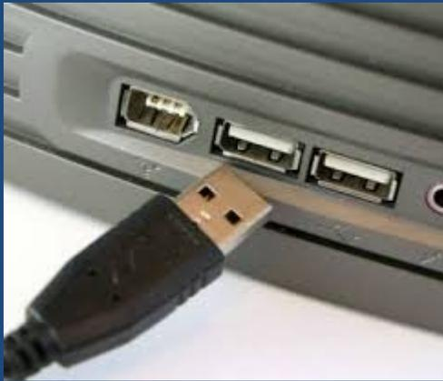
Les branchements USB sont présents à l'avant et à l'arrière des unités centrales et permettent de brancher au minimum 3 ou 4 périphériques compatibles.
