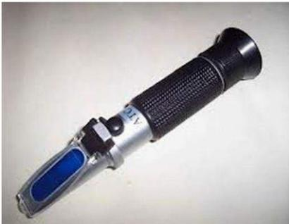
étalonnée jusqu'à 32. Cet appareil est fréquemment utilisé pour mesurer les sucres et amidons
